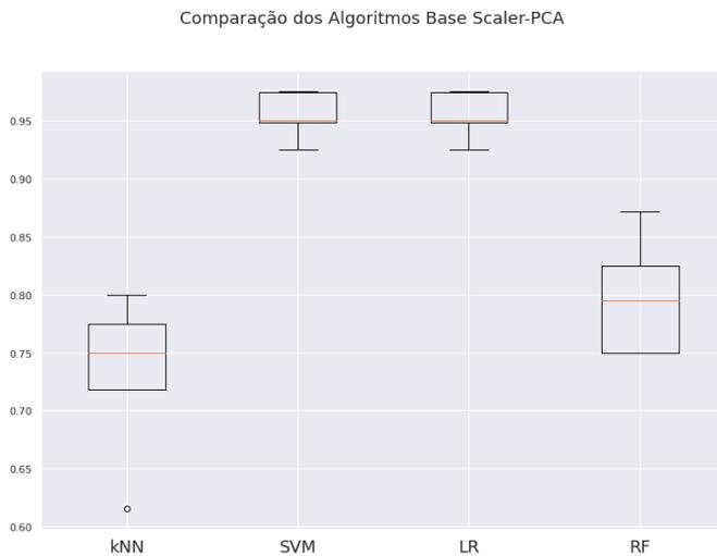
Figura 6.57: Desempenho e comparação dos classificadores de ML com o método Nested Cross-validation nos dados de pré-processamento Scaler PCA
