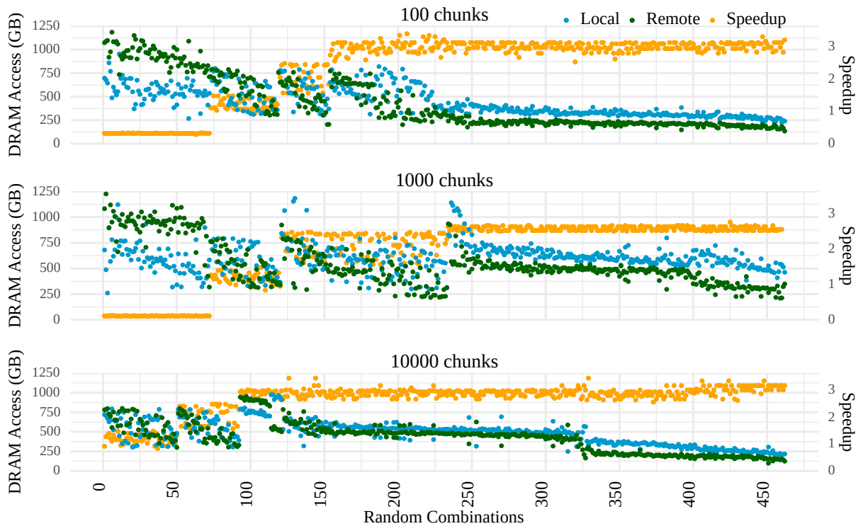
Figura 5.8: Desempenho e acessos à DRAM para todas as combinações de alocação de threads na máquina NUMA-SandyBridge . O experimento usa SAVIME executando o operador subarray em um banco de dados de 1 GB. Os resultados são ordenados pelo aumento de velocidade em comparação com o escalonador do SO.
